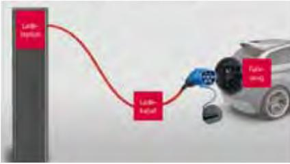
Das Ladekabel ist fest mit der Ladestation verbunden, wie der Tankschlauch an der Tankstelle. /11/
