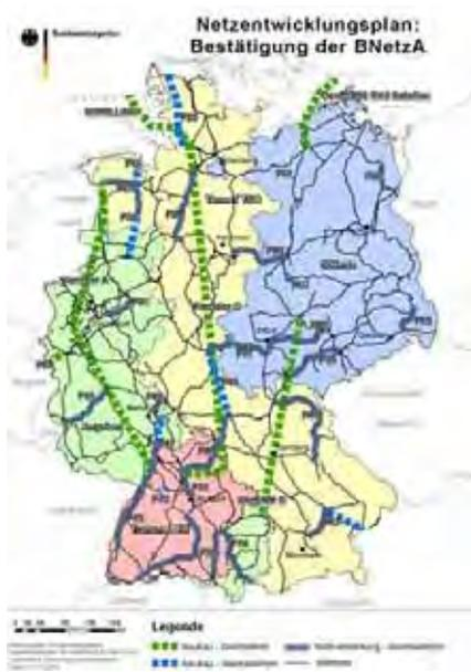
Bild 15: Beispielhafter Netzentwicklungsplan der BNetzA für Gesamtdeutschland
